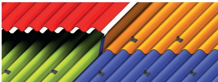
pour éviter quatre chevauchements à l'endroit où les angles se rencontrent, les angles des deux plaques centrales sont découpés. Un espace de 10 mm doit être laissé entre les arêtes angulaires vives.
